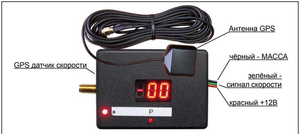
Рисунок 1. GPS Датчик скорости TAXO. Общий вид и схема подключения
